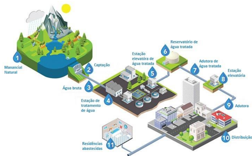
Figura 2: Abastecimento de água
