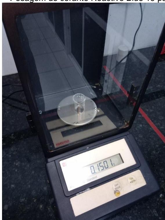
Figura 3 – Pesagem do corante Reactive Blue 19 para 0,15 \text{ g.L}^{-1}
