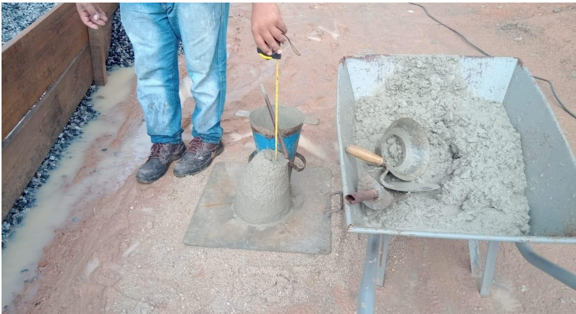
Figura 13 – Slump-Test - Ensaio de consistência do concreto.
