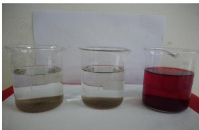
**Figura 4.** Amostras após o processo de floculação. Fonte: (Souza, 2019).
