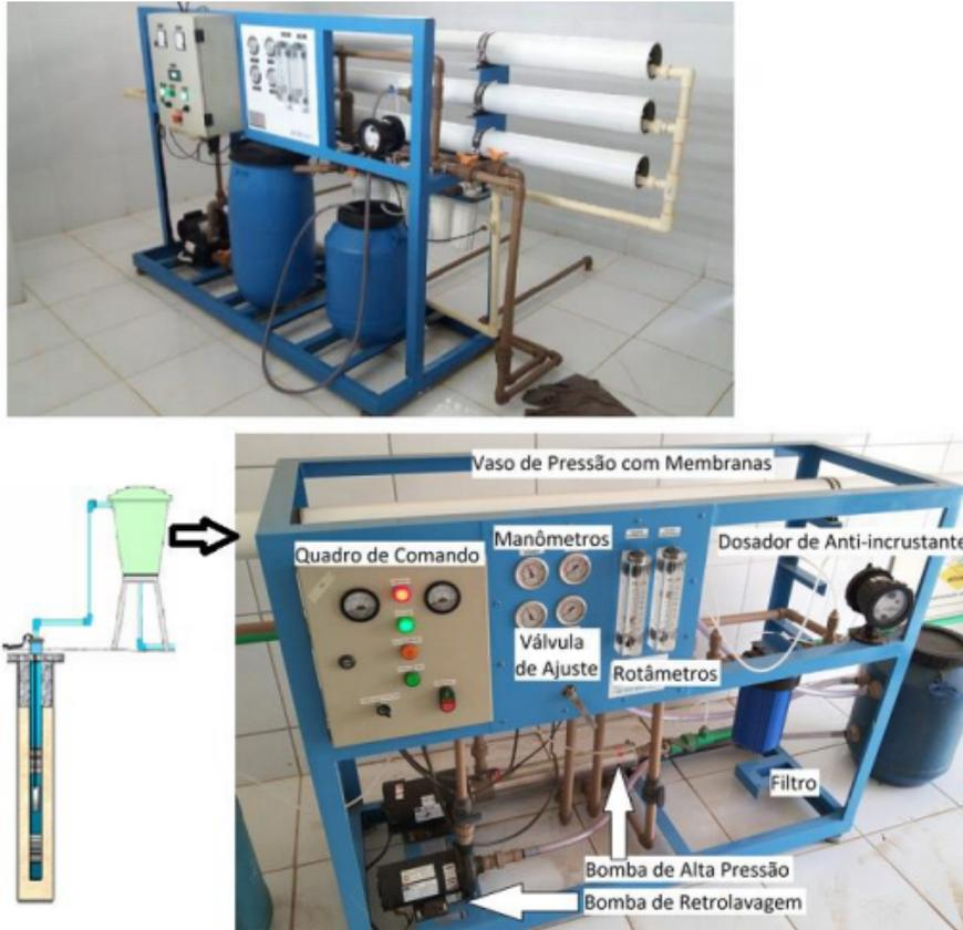
**Figura 8.** Dessalinizador por osmose inversa. Fonte: (HAGUENAUER, 2021).
