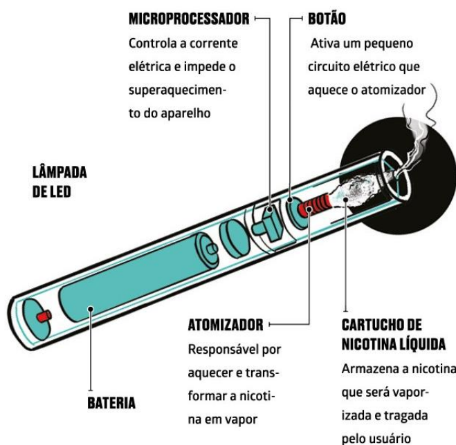
Figura 1: estrutura do cigarro eletrônico
