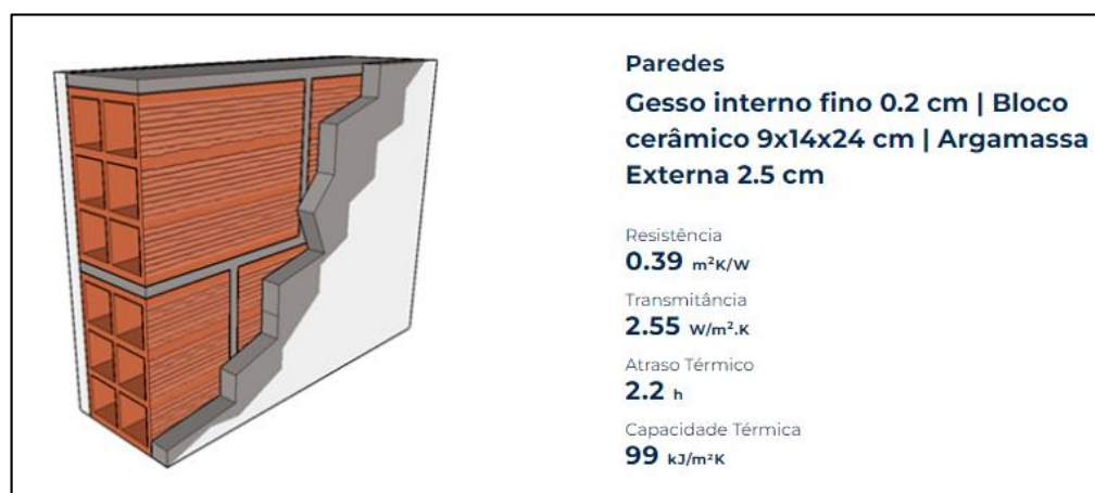
Figura 15 – Parede de Alvenaria de bloco cerâmico
