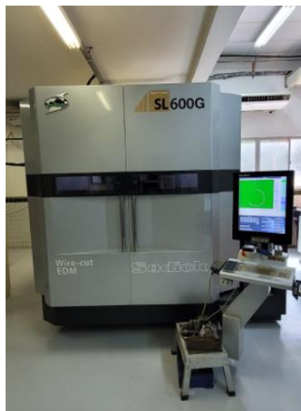
Figura 06 - Eletroerosão a fio CNC utilizada no desenvolvimento do ELMO®.
