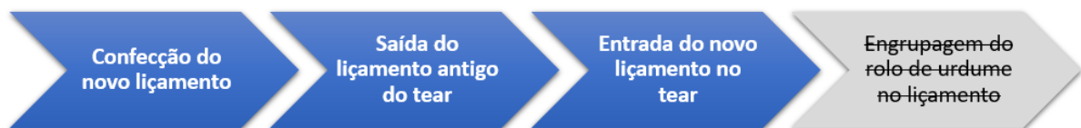
Figura 12.2 – Etapas do processo de Setup com remetadora automática.
