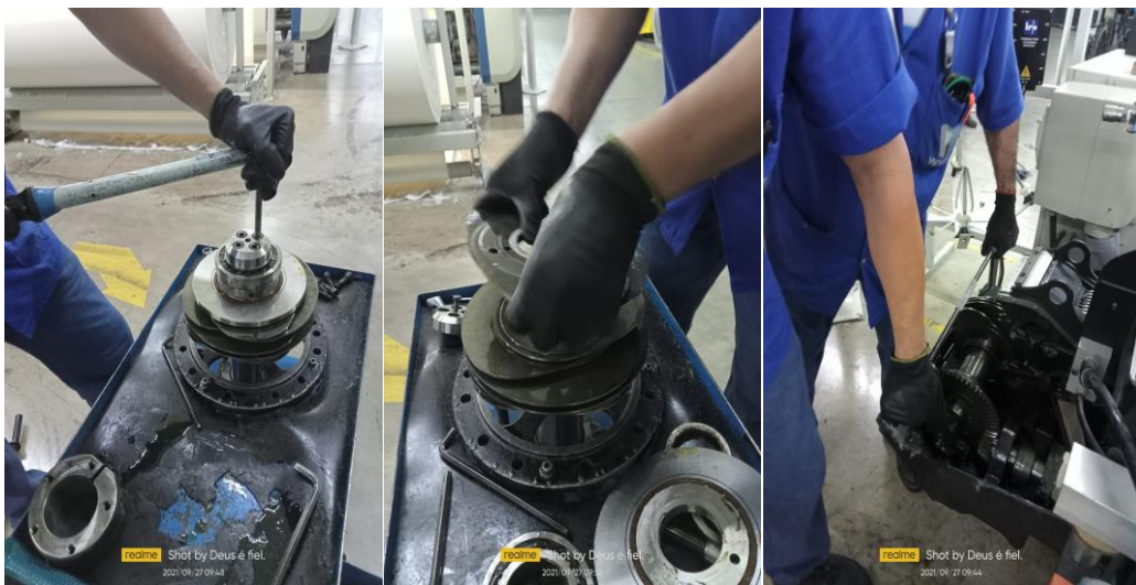
Imagem 06: Montagem de excêntricos.
