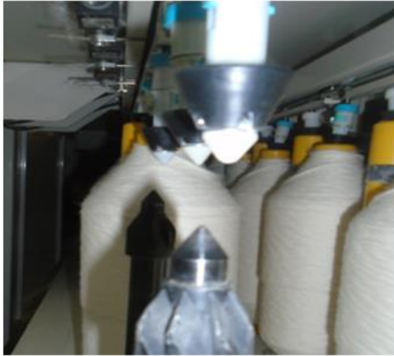
Figura 18 – Banco de troca desalinhado com a esteira
