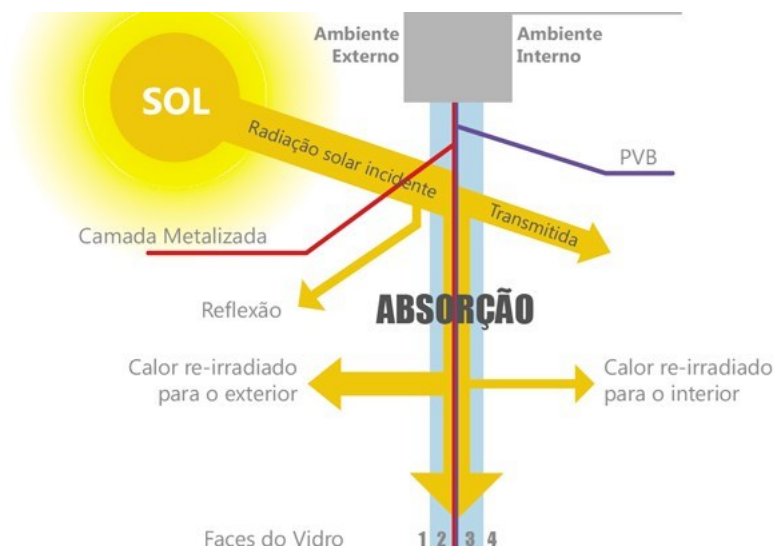
Figura 13 - Funcionamento do vidro de Controle Solar
