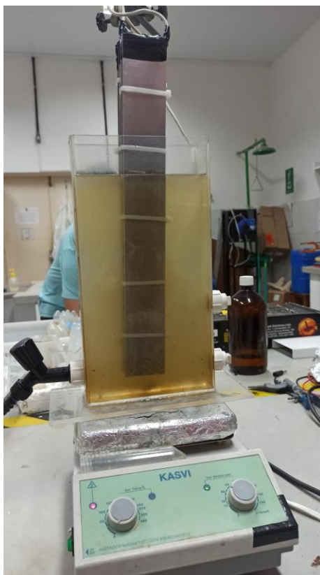
Figura 8: Preparação do reator e eletrodos
