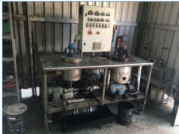
Figura 14 - Moinho piloto para fabricação de emulsão asfáltica.
