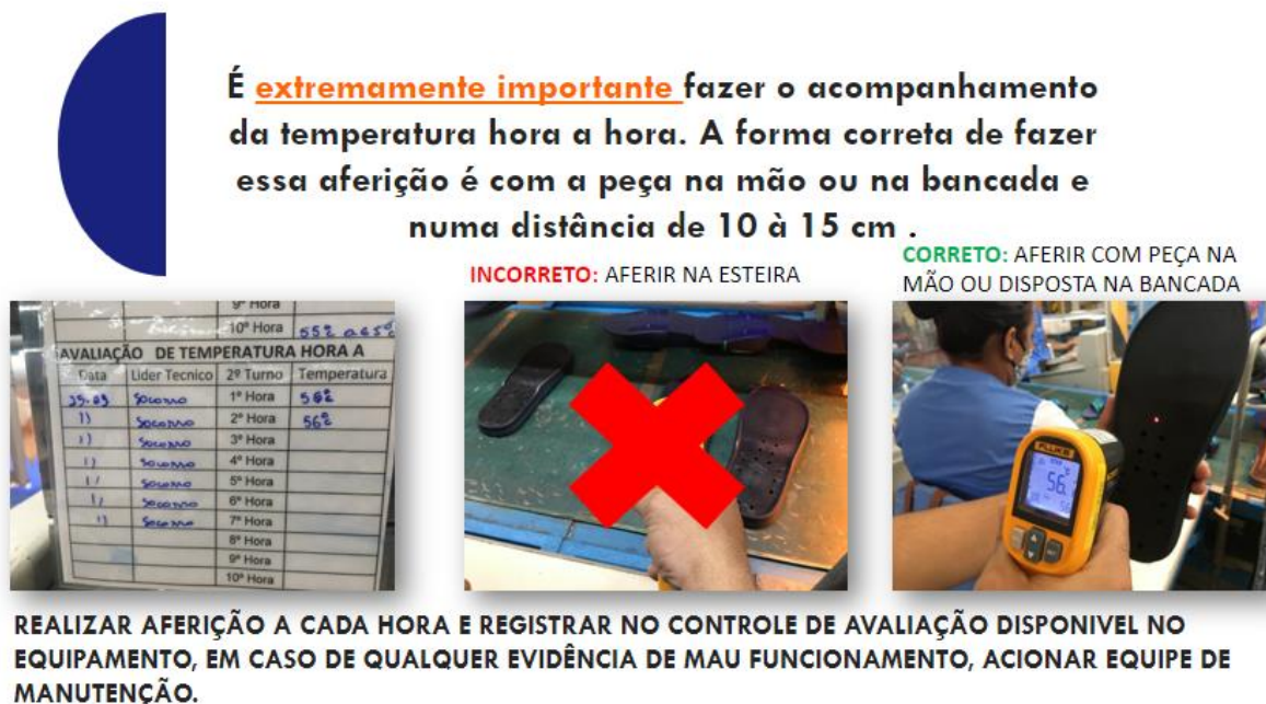
FIGURA 14 – MÉTODO DE AFERIÇÃO DE TEMPERATURA DOS COMPONENTES.
