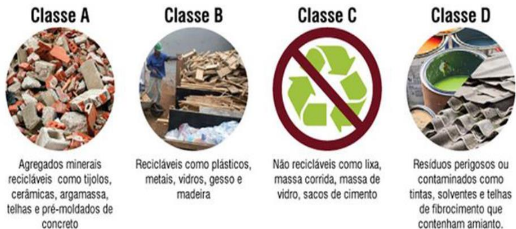
Figura 4 - Classes de resíduos da construção civil
