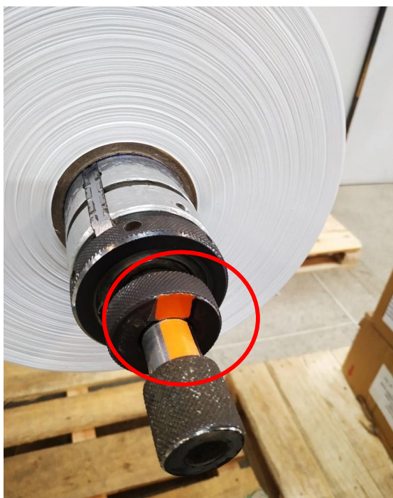
Figura 23. Marcação com adesivo da posição do eixo.
