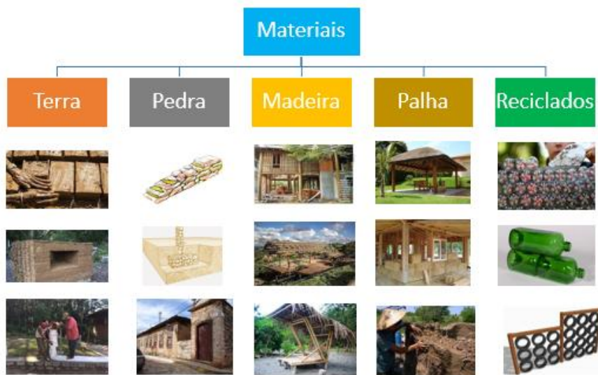
Figura 5 – Materiais utilizados nas Bioconstruções
